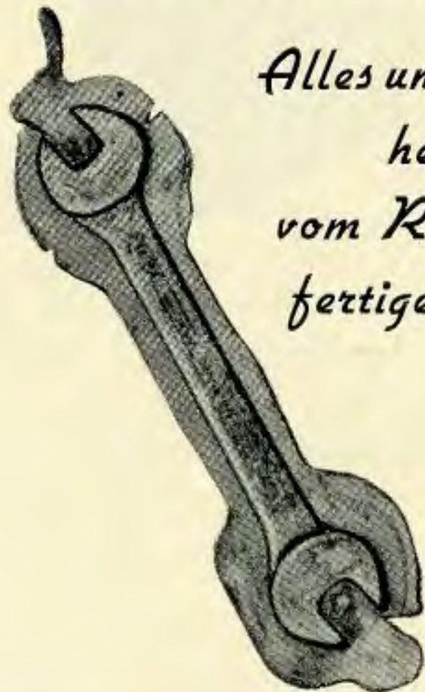
Spaltstück Schmiedestück Gefräst Gehärtet Feingepliebt Poliert Schmiederohling Abgegratet Geschliffen Gepliebt Vernickelt Verchromt
