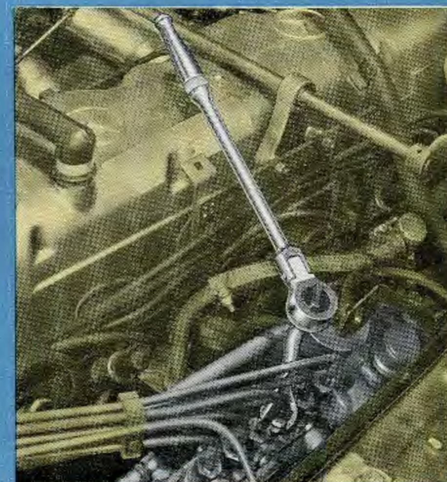
HAZET 2745 mit 8816 G für Überwurfmutter der Einspritzleitungen an Mercedes
