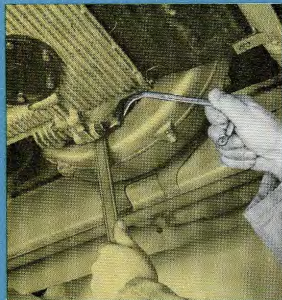
HAZET 2578 für Muttern des Ölpumpendeckels an VW
