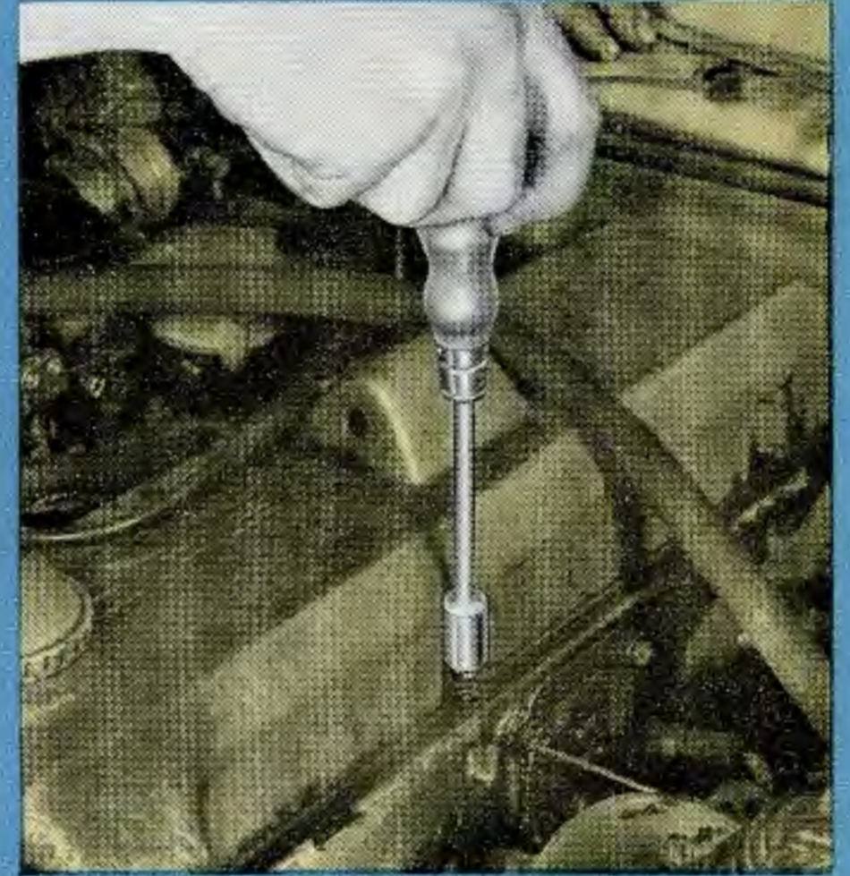
HAZET 421-10 mit Magnet für Ventildeckel-Schrauben an Opel
