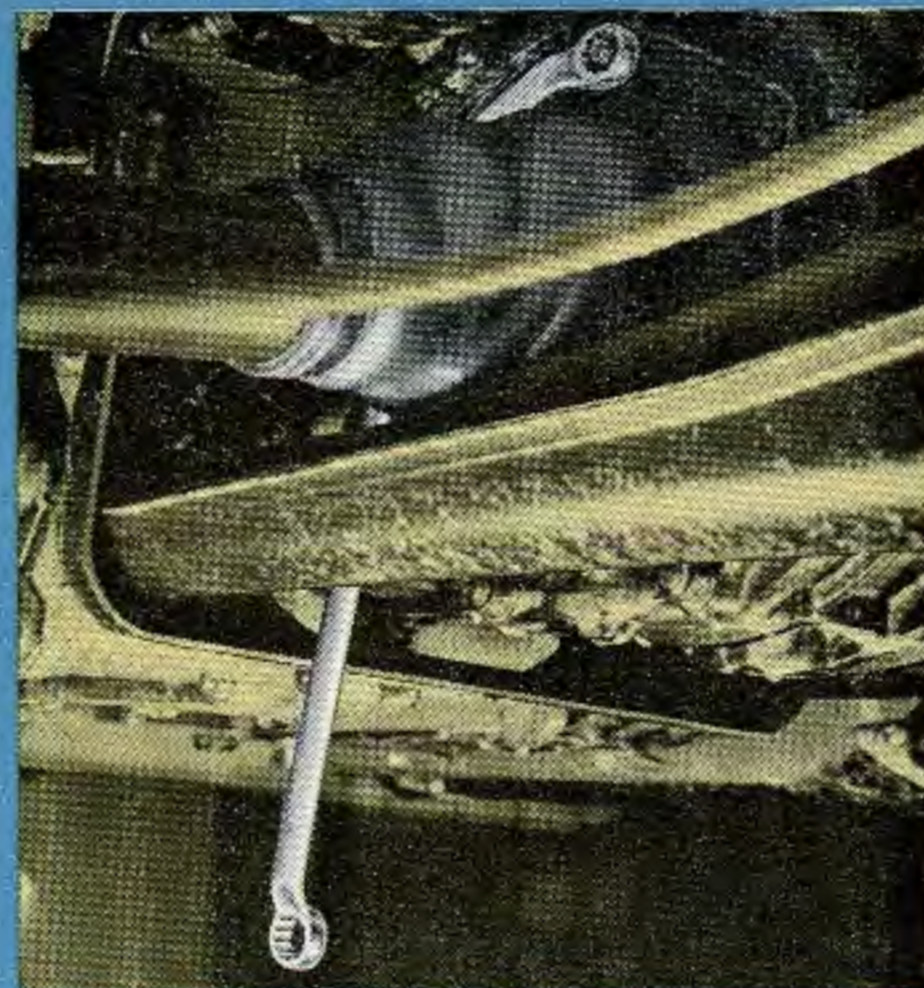
HAZET 2579 für Muttern am Lagerdeckel und Achsantriebdeckel an VW
